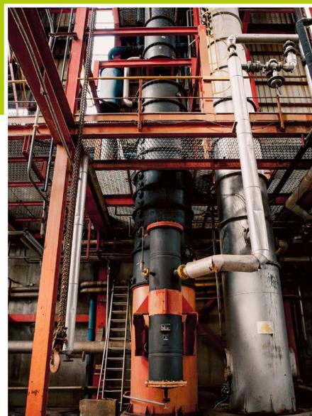
Colonne à distiller dans laquelle on envoie la vapeur faite par la chaudière.
