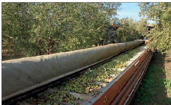
Ce tapis, à l'origine conçu pour la récolte des prunes et des cerises, a été adapté aux olives.
